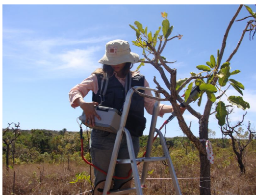
Figura 3. Medição das trocas gasosas foliares de um indivíduo adulto de Tabebuia aurea utilizando-se o analisador de gás por infravermelho portátil (IRGA).
