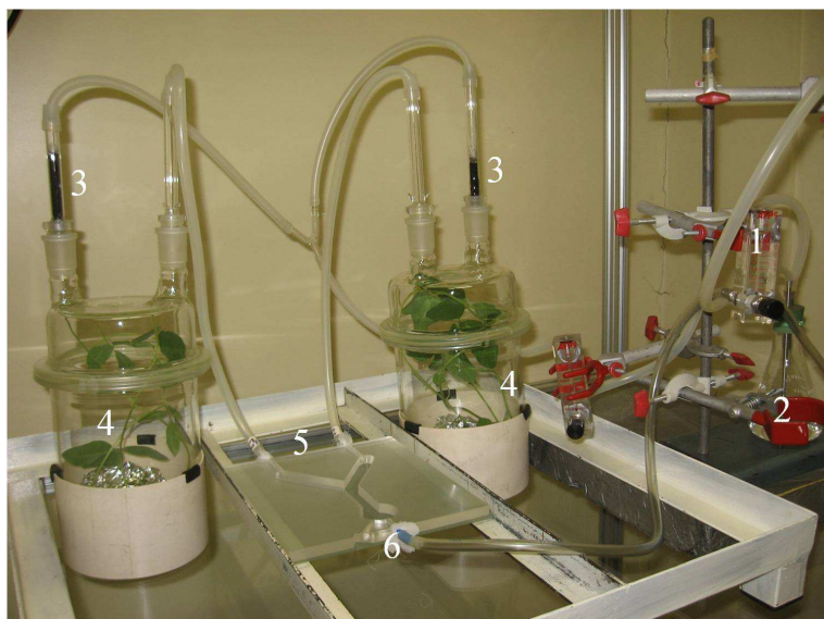
Figura 3: Olfatômetro em “Y” e outros equipamentos para condução de bioensaios: fluxômetro (1), umidificador (2), filtro de carvão ativado (3), câmara de vidro (4), entrada dos estímulos no olfatômetro (5), saída dos estímulos no olfatômetro (6).
